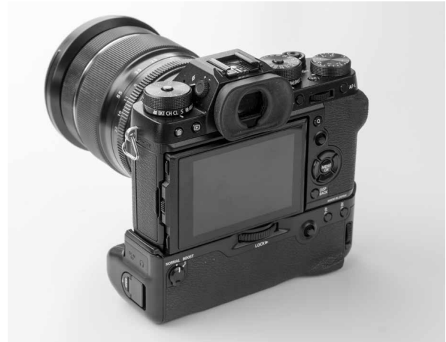
Der aufsetzbare Booster nimmt zwei zusätzliche Akkus auf: Serienaufnahmen im RAW-Format bis 11 Bilder/Sekunde.
